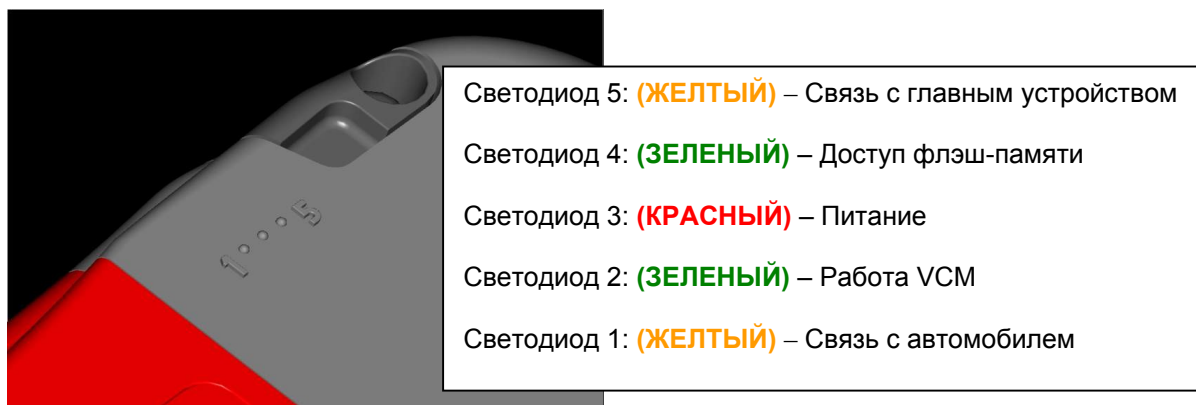
Рис. А. Расположение светодиодов под пластиковой крышкой
