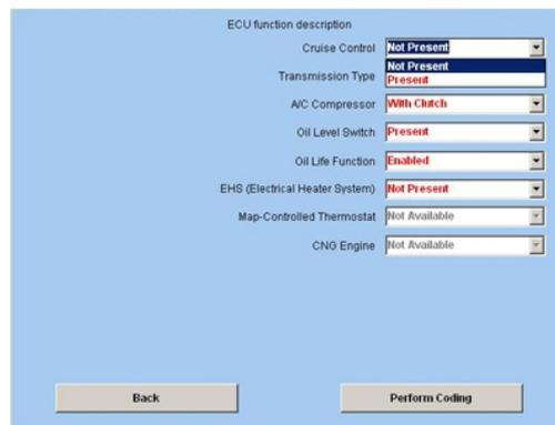
Далее сделаем аналогичную операцию с IPC модулем и попутно можем зайти в Output Tests, найти там тест Telltale Cruise Control и убедиться что лампочка на приборной панели вашего автомобиля работает.
